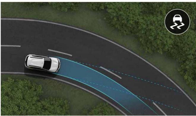
**sistema electrónico de estabilidad (ESP)**
